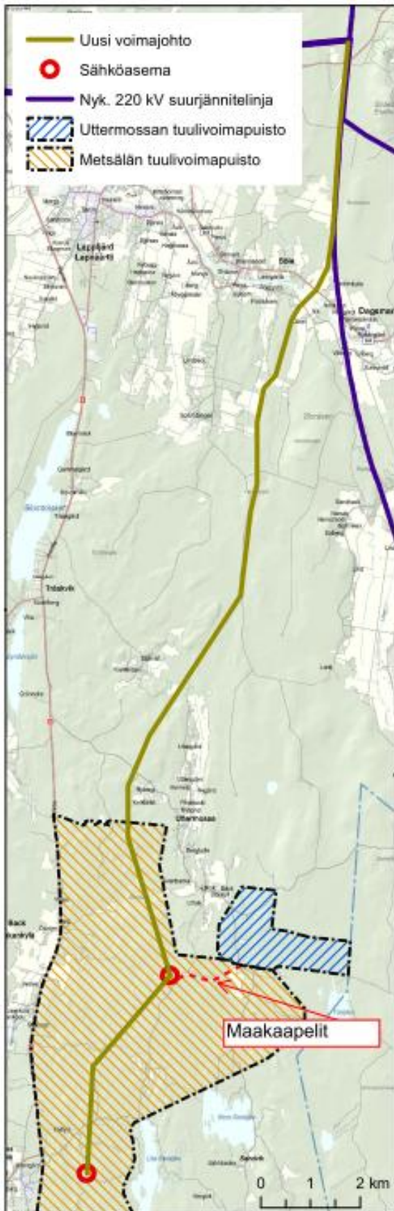
Kuva 4. Sähkönsiirtoreitti (110 kV) Metsälästä Pyhävuorelle. Kuvassa alustava suunnitelma yhteisen sähköaseman ja sähkönsiirtolinjan hyödyntämisestä sähkönsiirrossa. Metsälän OYK-rajaus on merkittynä oranssilla ja Uttermossan OYK-rajaus sinisellä rasteroinnilla.
